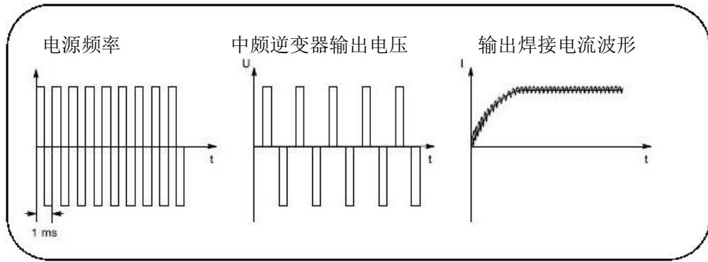
相较于普通的工频控制器，逆变中频控制器有着如下的优点：
