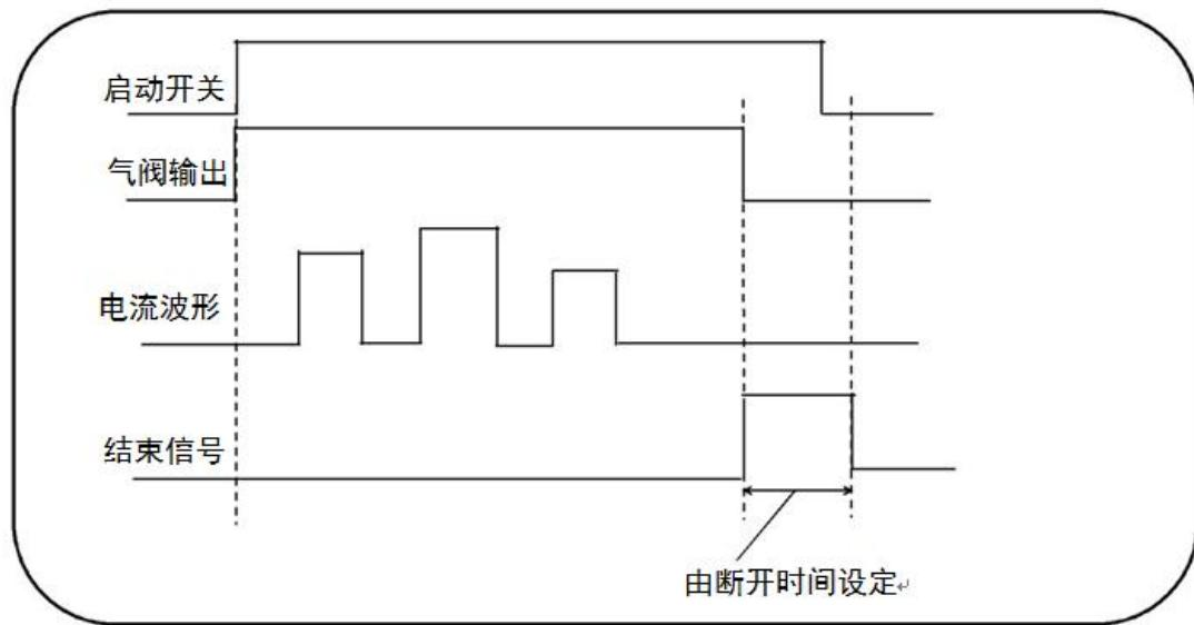
b) 连续点焊：连续点焊过程中，如果起动开关一直保持有效，那么电磁阀输出在维持时间过后会断开，然后输出保持终了信号，休止时间过后电磁阀会再次闭合，重新开始下一个焊接过程。下图为连续点焊时的工作时序图：
