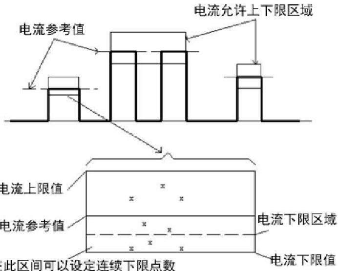
1、焊1（焊2或焊3）参考值：可以设定一个实际的电流参考值，电流上限、电流下限值等参数都以这个参考值为标准。
