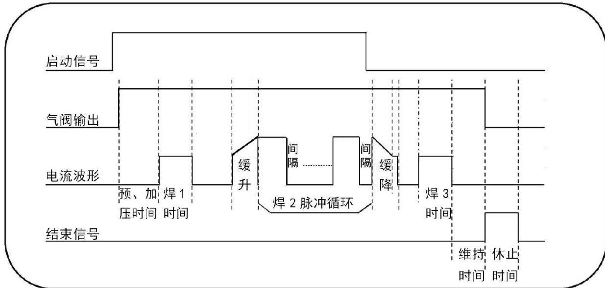
b) 当启动信号自保持为 1 时是两脚缝焊，即第一次启动后，第二脉冲循环输出，形成缝焊过程，第二次启动后焊接循环结束。下图为脉冲启动缝焊时的工作时序图：
