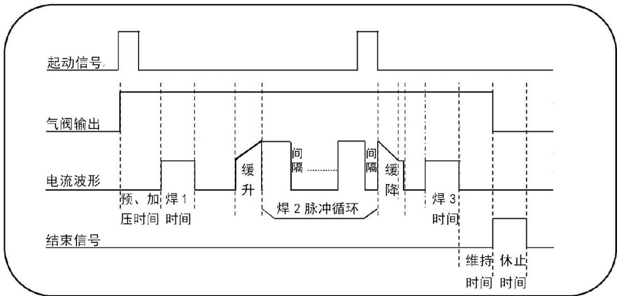
循环电流可随时切换四种不同的电流设定值。当编程参数“缝焊定时”设为 1 时，编程定时切换有效。
