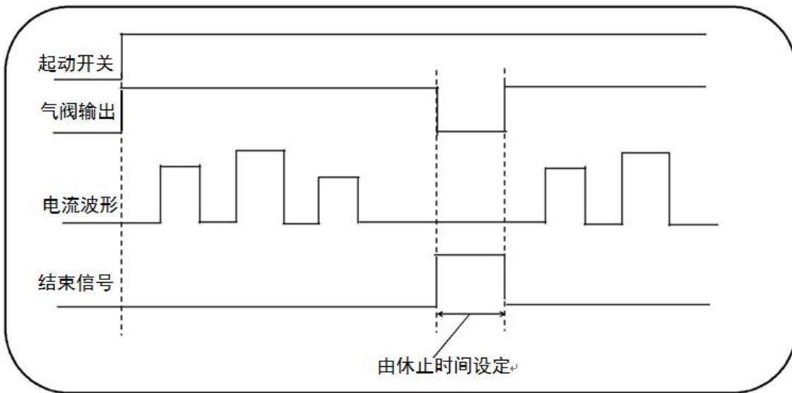
6.2 缝焊方式：此方式分为常规和两脚两种形式。（只固定点方式有效，机器人方式不支持）
