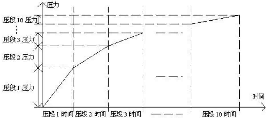
2、压段1压力: 压力步增段 1 压力相对于最大压力的百分比, 同理, 每一个压力步增段都对应一个压力值。它以比例阀的最大输出压力为基准。
